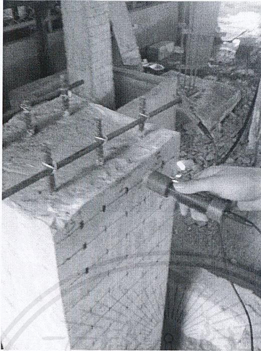
รูปที่ ผ.ค. 93 แสดงการตรวจวัดการเกิดสนิมด้วยเครื่อง Half-Cell Potential Instrument
