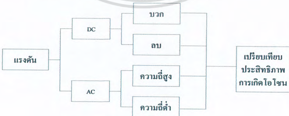
รูปที่ 4.2 ไตอะแกรมการทดลองหาค่าพารามิเตอร์
