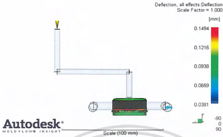
รูปที่ ผค 73 ผลการทดลองการโก่งตัวของชิ้นงานฝาขวดพลาสติก ครั้งที่ 15
