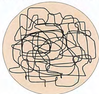
รูปที่ 2.30 ลักษณะโครงสร้างของ Amorphous Thermoplastics [13]
