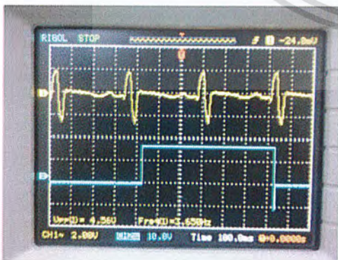
รูปที่4.8 กราฟที่แสดงผลออกทางออสซิลอสโคป โดยเครื่องกระตุ้นกล้ามเนื้อที่ PW= 100 ms.
