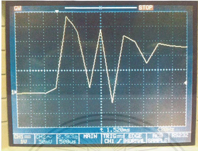
รูปที่ 4.16 สัญญาณที่ใช้ไม้กลองเคาะโดยเปียโซวางอยู่บนโต๊ะ
