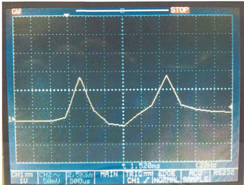
รูปที่ 4.18 สัญญาณที่ใช้ไม้กลองเคาะโดยเปียโนวางอยู่บนแผ่น CD
