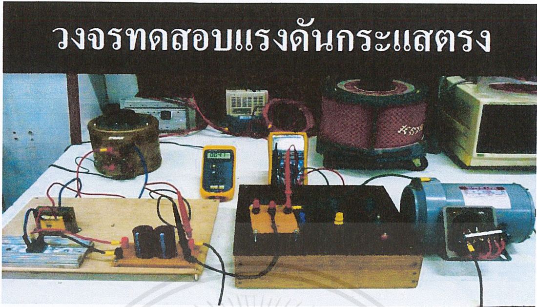
ภาพที่ 4.2 การวัดแรงดันไฟฟ้าที่ป้อนเข้าและแรงดันไฟฟ้าที่ตกคร่อมตัวต้านทานด้วยแรงดันไฟฟ้ากระแสตรง
