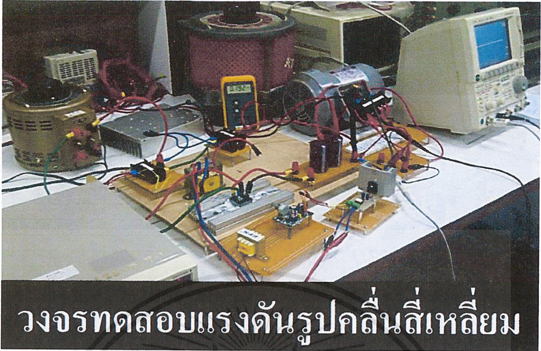
ภาพที่ 4.5 การวัดแรงดันไฟฟ้าที่ป้อนเข้าและแรงดันไฟฟ้าที่ตกคร่อมตัวต้านทานภายนอก ด้วยแรงดันไฟฟ้ารูปคลื่นสี่เหลี่ยมความถี่สูง
