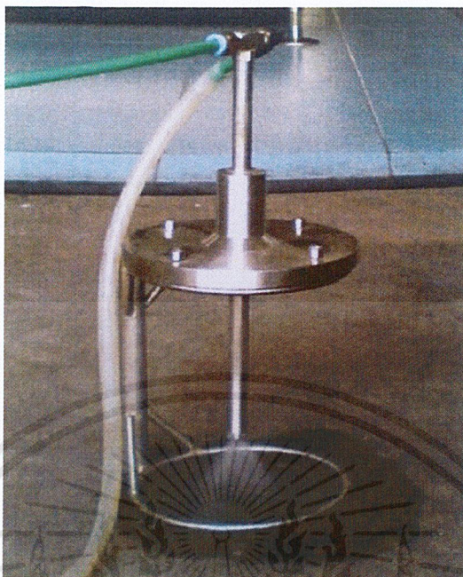
ภาพที่ ก.5 แสดงหัวฉีดแบบ Two Fluid Nozzle
