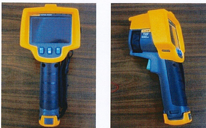
รูปที่ 3.4 กล้องถ่ายภาพความร้อน รุ่น TI 32
