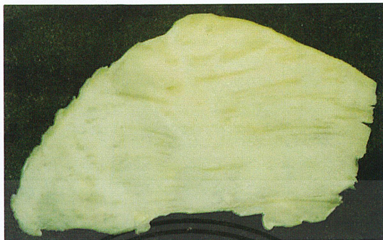
รูปที่ 15 เนื้อทุเรียนทดสอบที่ระยะห่างช่องใบมีด 1.45mm ความเร็วรอบ 320 rpm
