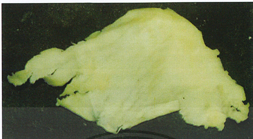
รูปที่ 21 เนื้อทุเรียนทดสอบที่ระยะห่างช่องใบมีด 1.95mm ความเร็วรอบ 400 rpm
