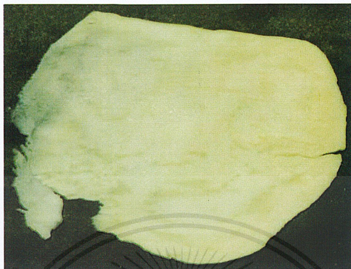
รูปที่ 19 เนื้อทุเรียนทดสอบที่ระยะห่างช่องใบมีด 1.95mm ความเร็วรอบ 250 rpm
