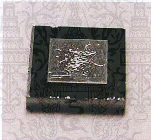
รูปที่ 4.2 ตัวตรวจจับรังสีเอ็กซ์ที่สร้างเสร็จสมบูรณ์และบรรจุลงในตัวถัง
