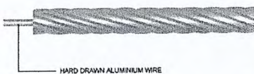
รูปที่ 4 แสดงภาพของ AAC และคุณสมบัติของสายของบริษัท Thai-Yazaki
