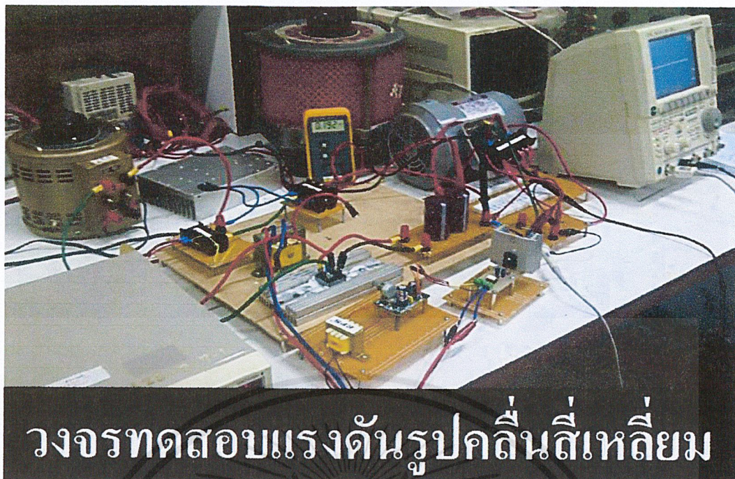
ภาพที่ 4.5 การวัดแรงดันไฟฟ้าที่ป้อนเข้าและแรงดันไฟฟ้าที่ตกคร่อมตัวต้านทานภายนอก ด้วยแรงดันไฟฟ้ารูปคลื่นสี่เหลี่ยมความถี่สูง
