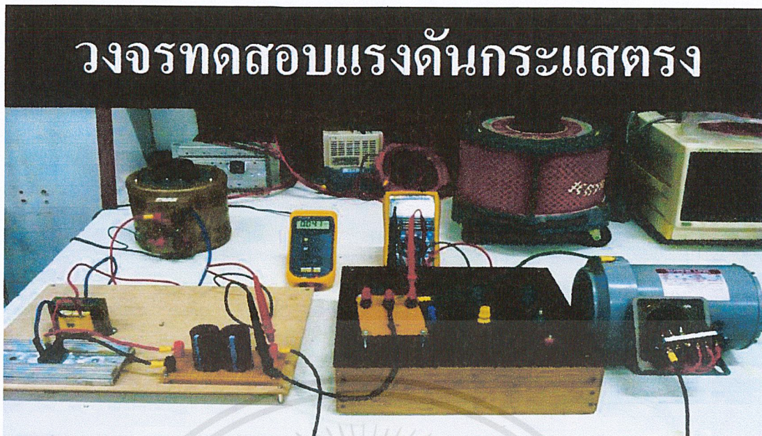
ภาพที่ 4.2 การวัดแรงดันไฟฟ้าที่ป้อนเข้าและแรงดันไฟฟ้าที่ตกคร่อมตัวต้านทานด้วยแรงดันไฟฟ้ากระแสตรง
