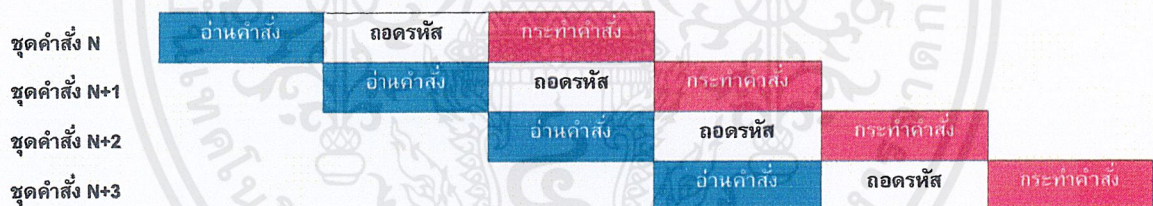
รูปที่ 2.14 กระบวนการไปป์ไลน์ของ Cortex-M3 โปรเซสเซอร์
