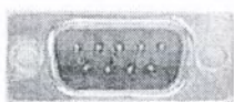
รูปที่ 2.12 พอร์ตอนุกรมของ PC DB9 ตัวผู้ (Male)
