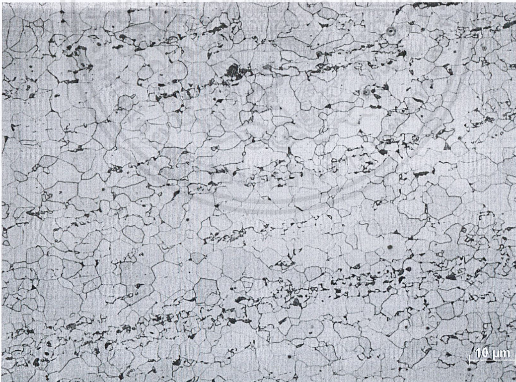
รูปที่ 4-33 โครงสร้างที่ผ่านการอบ 700 °C, 1 hr Grain size No. 13.64
