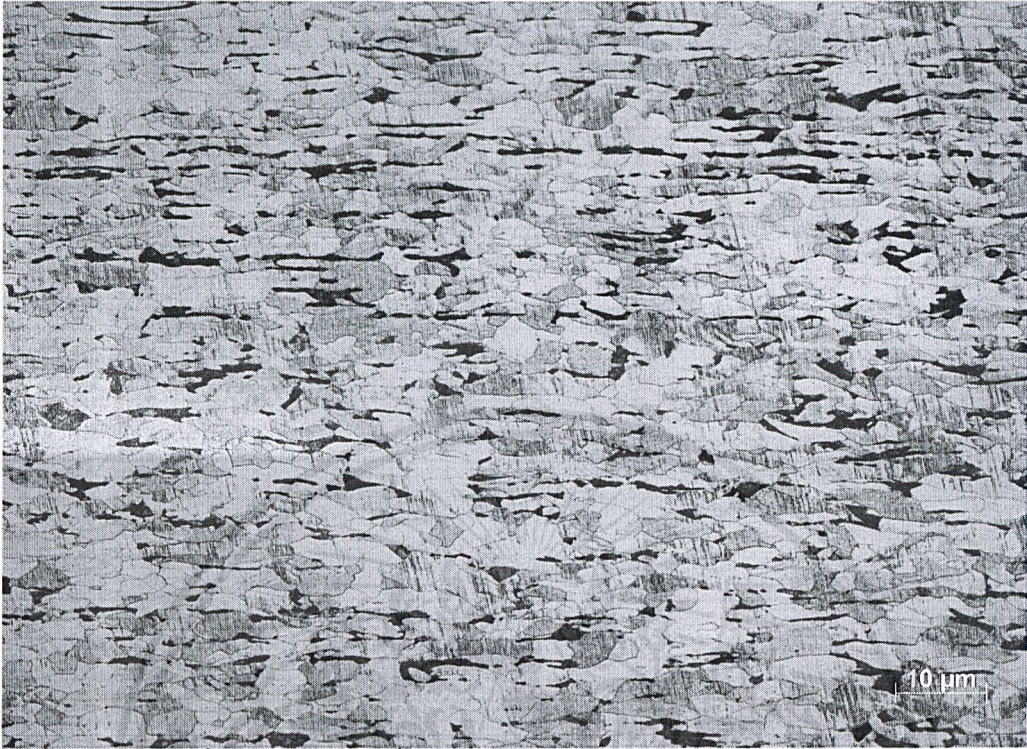
รูปที่ 4-30 โครงสร้างที่ผ่านการ Normalizing และการรีดลดขนาด
