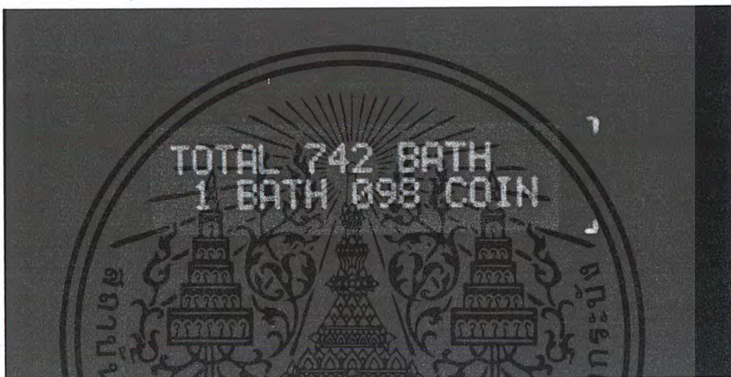
รูปที่ 5.1 LCD Display แสดงมูลค่ารวมของเหรียญทั้งหมดที่นับได้
