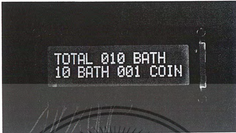
รูปที่ 4.17 LCD Display แสดงผลเมื่อเหรียญชนิด 10 บาทถูกนับ
