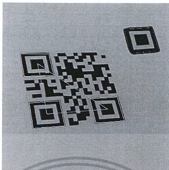
รูป 3.16 การกรองแพทเทิร์นที่ไม่ต้องการออก
