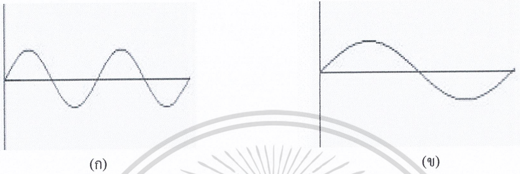
รูปที่ 2.5 การเปรียบเทียบการสั่นสะเทือนของเสียงสูง(ก) และเสียงต่ำ (ข)
