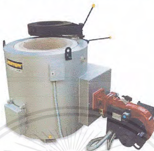
รูปที่ 5.15 เตาหลอมอลูมิเนียมชนิดเตาเบ้าแบบมีฝาปิดที่ถูกต้อง
