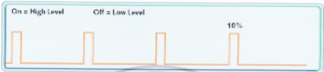
รูปที่ 2.11 แสดงสัญญาณ PWM ซึ่งแสดงค่า Duty Cycles 10%
