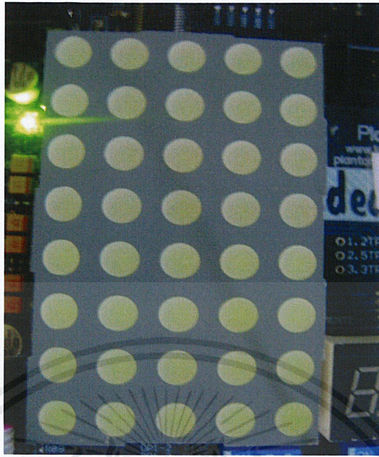
รูปที่ 4.13 ผลการทดลองควบคุมความส่องสว่างของ DOT Matrix LED ที่ความถี่ 5 kHz
