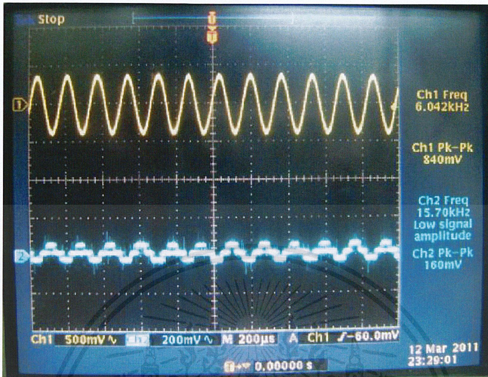
รูปที่ 4.6 ผลการทดลองวงจรกรองที่ความถี่ย่าน 6 kHz
