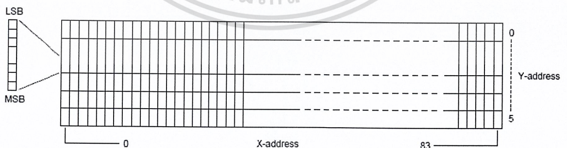
รูปที่ 3.16 ตำแหน่งของ MSB และ LSB ของข้อมูลขนาด 8 บิต
