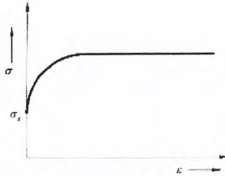
รูปที่ 3.15 ความสัมพันธ์ระหว่างความเค้นและความเครียดของโลหะที่มีพฤติกรรมเป็นแบบ Elastic – Steady State Plastic
