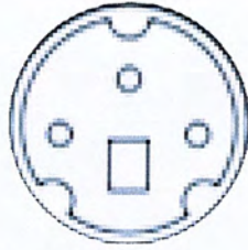
รูป ก.2 หัวต่อ 3-pin mini-DIN
