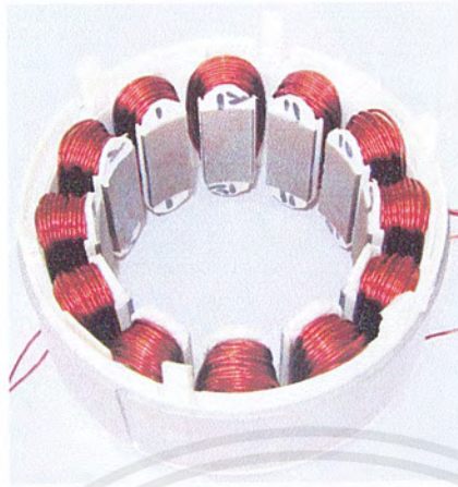
รูปที่ 2.1 แสดงสเตเตอร์ของมอเตอร์ไฟฟ้ากระแสตรงแบบ ไร้แปรงถ่าน
