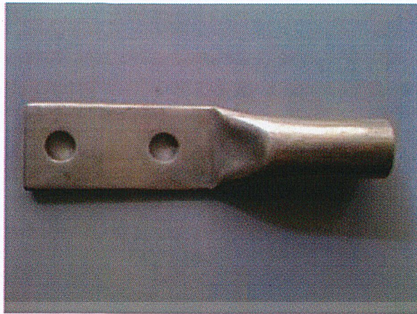
ภาพที่ 4.10 หางปลาอลูมิเนียมทำจากสแตนเลสสภาพใหม่
