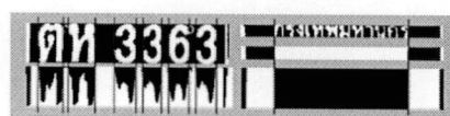
ภาพที่ 8: การทำโปรเจกชันแนวตั้งด้วยอักษรรัดที่หนึ่ง (ซ้าย) และด้วยอักษรรัดที่สอง (ขวา)
