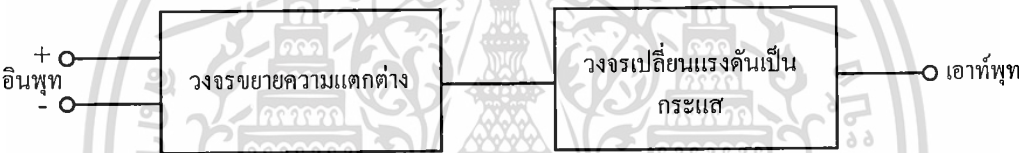
รูปที่ 2.16 บล็อกไดอะแกรมโครงสร้างพื้นฐานของโอทีเอ
