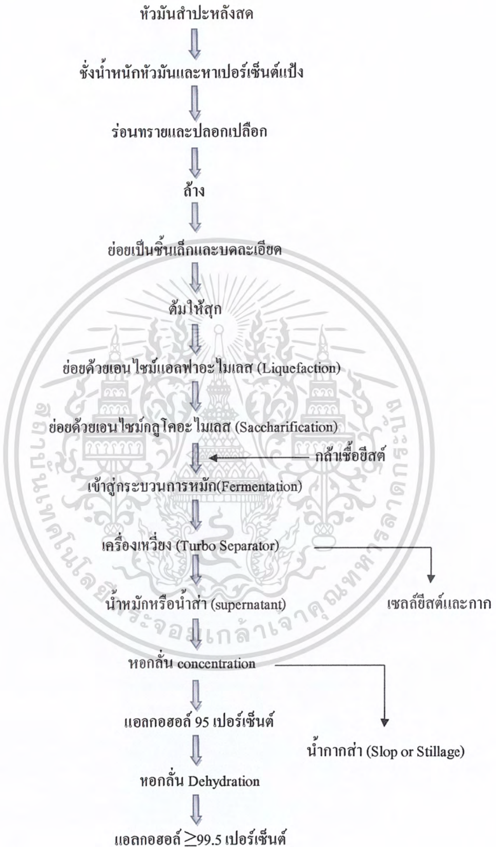
รูปที่ 2.2 กระบวนการผลิตเอทานอลจากวัตถุดิบหัวมันสำปะหลังสด
