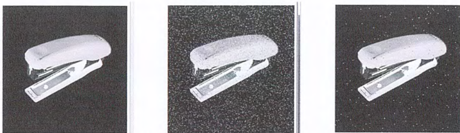
รูป 4.10 การทำ smoothing ด้วย MATLAB โดยรูปมีขนาด 300x300 ใช้ตัวกรองขนาด 3x3
