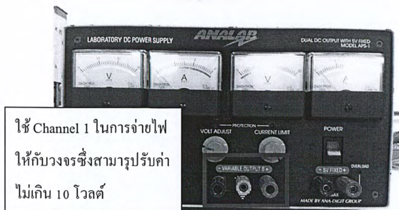
รูป 4.24 พาวเวอร์ซัพพลายที่ใช้เป็นแหล่งจ่ายไฟให้กับวงจร
