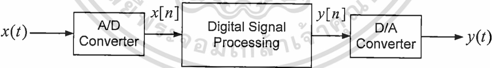
รูปที่ 3.2 โครงสร้างระบบประมวลผลสัญญาณดิจิทัล
