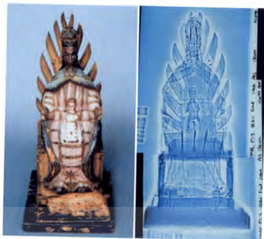
รูปที่ 2.16 แสดงการใช้ Xeroradiography ในการตรวจสอบวัตถุต่างๆ
