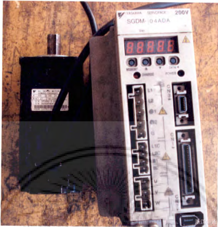
รูปที่ 3.9 แสดงเซอร์โวมอเตอร์กระแสสลับและชุดควบคุมเซอร์โวมอเตอร์ที่ใช้ในงานวิจัยนี้
