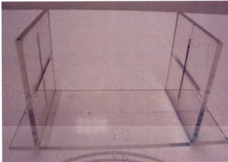
รูปที่ 3.14 เฟรมทอมปรับตั้ง ทำจากแผ่นอะคริลิกและติดด้วยเข็มโลหะ
