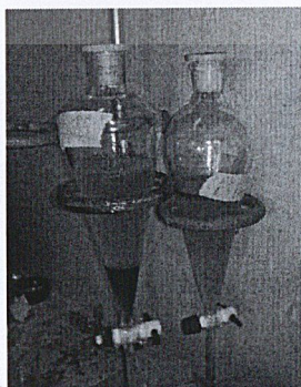
รูปที่ 3.6 แสดงการแยกชั้นของเมทิลเอสเทอร์และกลีเซอรอล
