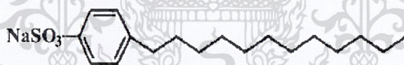
รูปที่ 2.31 โครงสร้างของ Sodium dodecylbenzenesulfonate (SDBS) [41]
