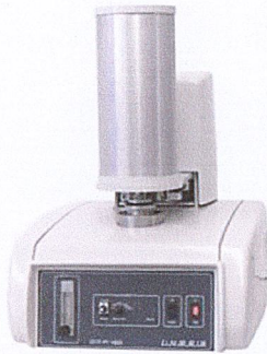
รูปที่ 2.9 เครื่องวิเคราะห์แบบดิฟเฟอร์เรนเชียล เทอร์มอล (DTA) [25]
