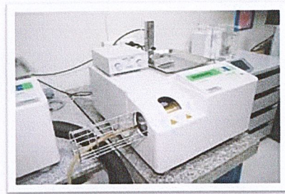
รูปที่ 2.10 เครื่องวิเคราะห์ทางความร้อน ดิฟเฟอร์เรนเชียลสแกนนิ่งแคลอริมิเตอร์ (Differential Scanning Calorimeter) [26]
