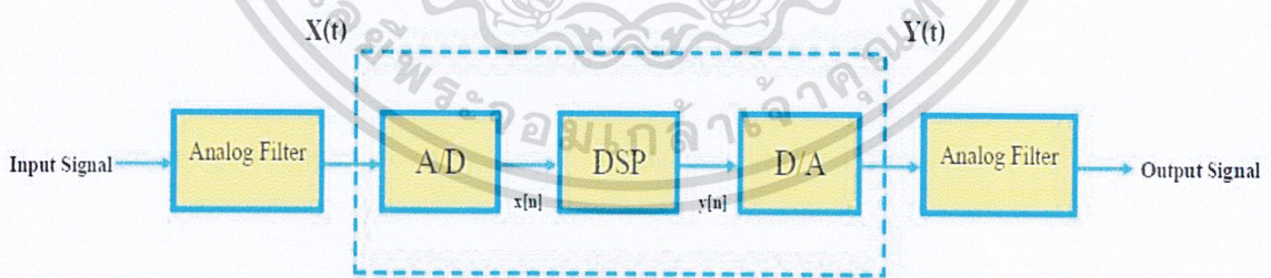
รูปที่ 2.1 ไดอะแกรมการทำงานของตัวกรองดิจิทัลพื้นฐาน
