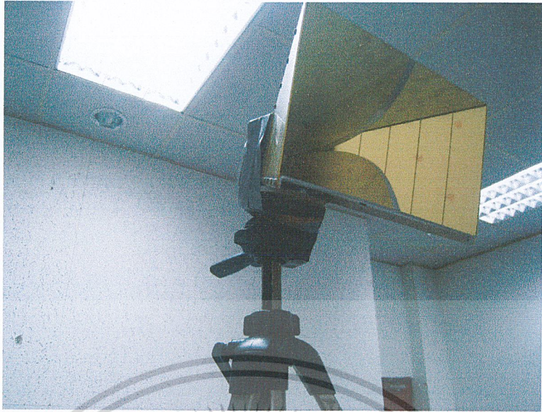
รูปที่ 3.3 สายอากาศด้านส่งใช้สายอากาศปากแตร
