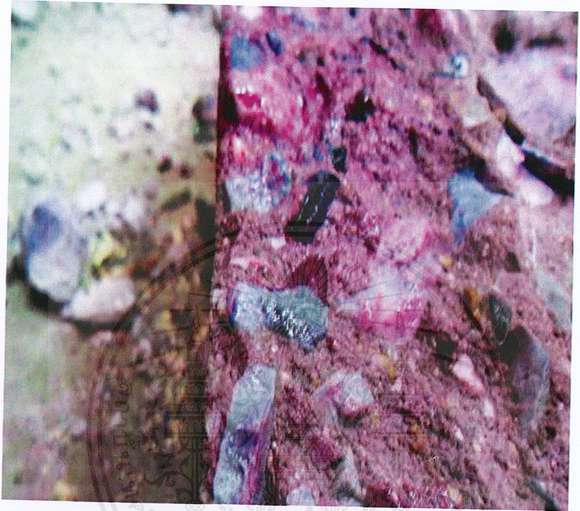
รูปที่ ผก.26. ลักษณะของตัวอย่างที่ไม่เกิดปฏิกิริยา รูปที่ 1
