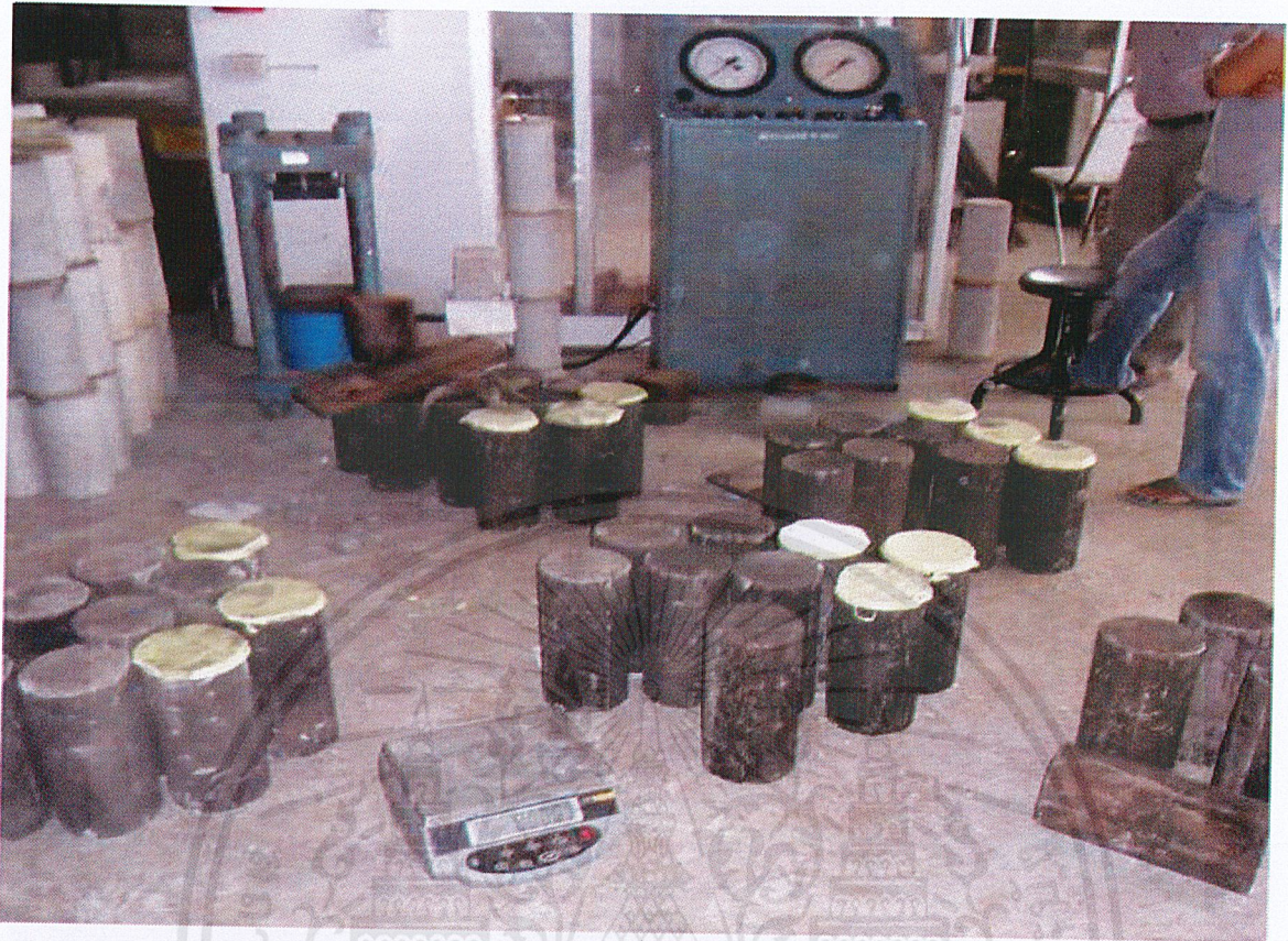
รูปที่ ผก.20. วัดปริมาตรและน้ำหนักของตัวอย่างหลังทดสอบ
