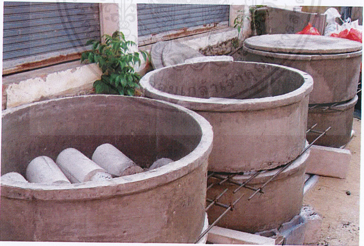
รูปที่ ผก.15. ปิดฝาเตาเผาทดสอบแล้วใส่เชื้อเพลิงด้านล่าง
