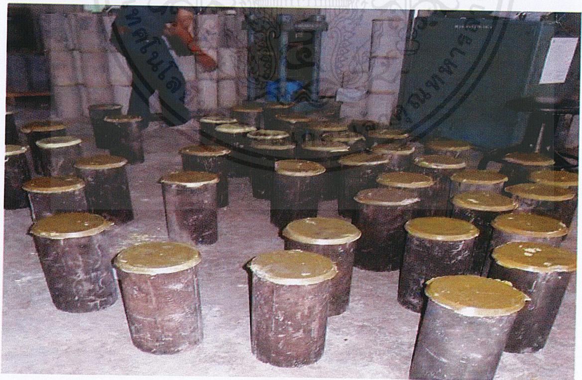
รูปที่ ผก.21. ครอบหัวตัวอย่างหลังการทดสอบในด้านที่ไม่เรียบ
