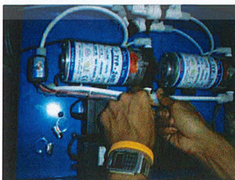
รูปที่ ผ.ค.7. การประกอบ Pump Motor 100 G
