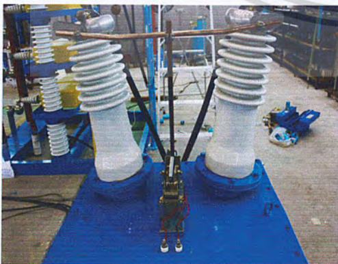
ภาพที่ 3.26 ระบบกรวดหม้อแปลงอัดประจุที่ได้ทำการประกอบสร้างจริง
