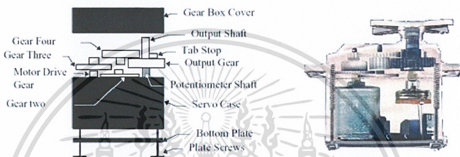
รูป 3.2 แสดงภายในของเซอร์โวมอเตอร์
