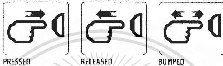
รูปที่ 2.12 สถานะที่เซนเซอร์สัมผัสตรวจจับได้ ( http://mindstorms.lego.com/eng/Overview/Touch_Sensor.aspx )
