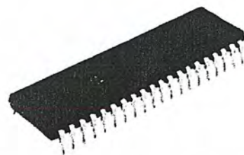
รูปที่ 3.1.1.2 microcontroller PIC 16F877A
