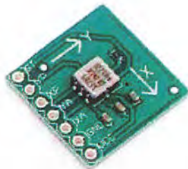
รูปที่ 4.2 เซนเซอร์วัดความเร่ง ADXL202JE
