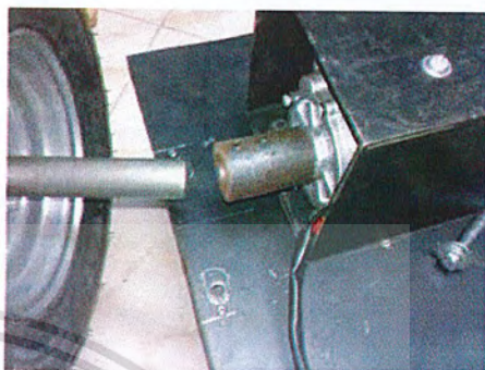
รูปที่ 8.8 รูปแสดงส่วนของล้อและรูปแสดงการประกอบล้อเข้ากับมอเตอร์
