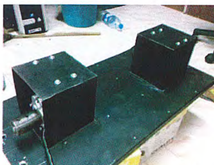
รูปที่ 8.7 แสดงส่วนฐานของหุ่นยนต์มาประกอบกับกล่องใส่มอเตอร์
