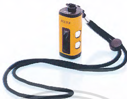
รูป 5.11 เครื่องรับสัญญาณ GPS Holux m-241 Wireless GPS Logger
