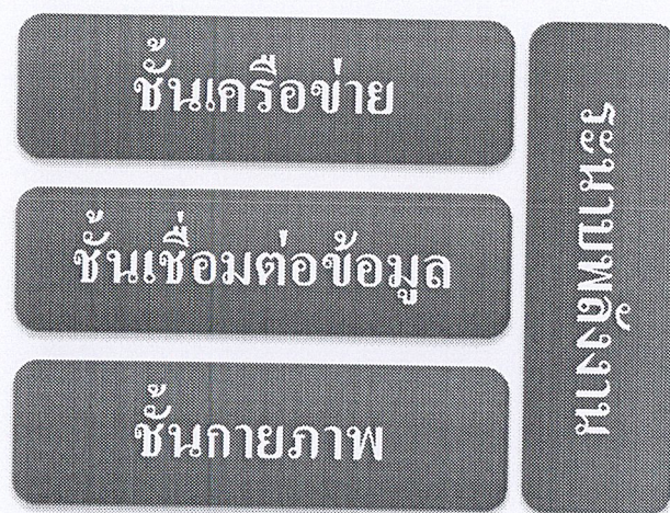
รูปที่ 2.4 ระดับชั้น โปรโตคอลของเครือข่ายสื่อสารไร้สาย [3]
