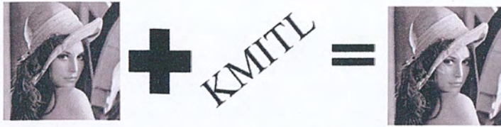
รูป 5.2 ตัวอย่างการฝังภาพลายน้ำแบบ Additive watermarking
