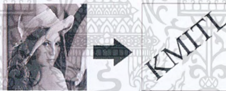
รูป 5.3 ตัวอย่างการถอดภาพลายน้ำแบบ Substitution watermarking
