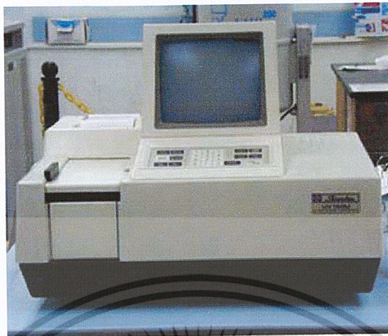
รูปที่ 2.15 UV-Vis Spectrophotometer ของ Shimadzu สามารถวัดการดูดกลืนได้ทั้งในช่วงแสงอัลตราไวโอเล็ตและแสงที่มองเห็นได้ และสามารถสแกนสเปกตรัมได้
